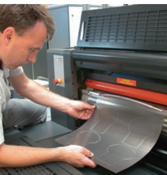
Das Inline-Stanzblech wird auf dem Magnetzylinder der Druckmaschine eingepasst.
